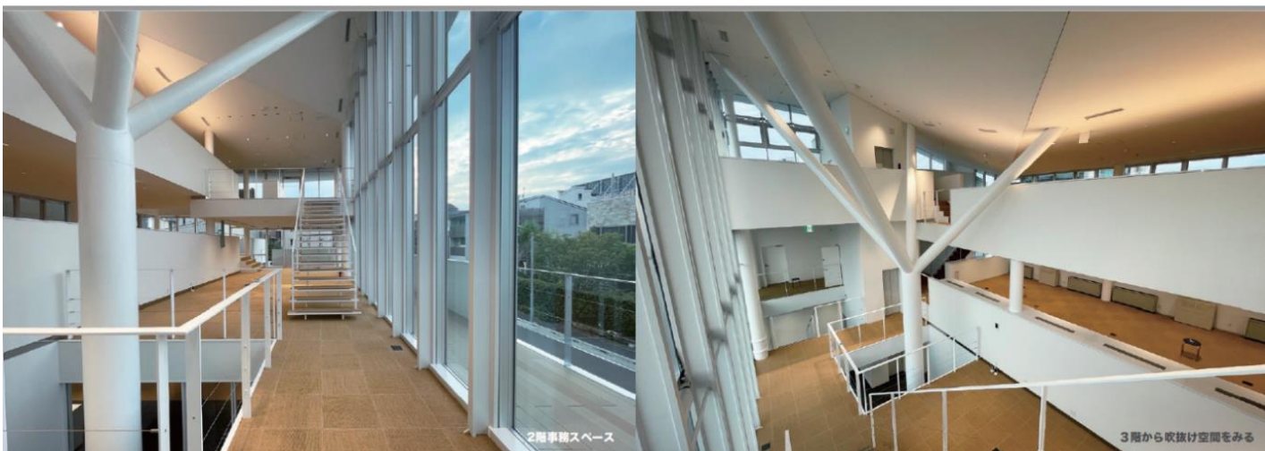
大きな-しろひげ-の木は、吹抜け空間を通じて、大屋根を支える構造体となっています。
